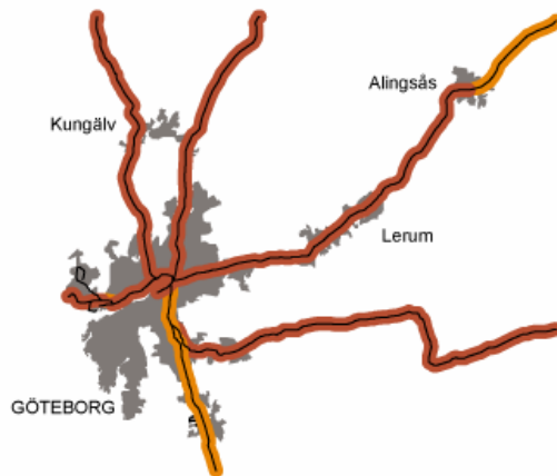
Figur 2-14 Stora (röda) respektive måttliga (orangea) kapacitetsproblem i järnvägsnätet i/kring Göteborg över dygnet (Källa: WSP)
